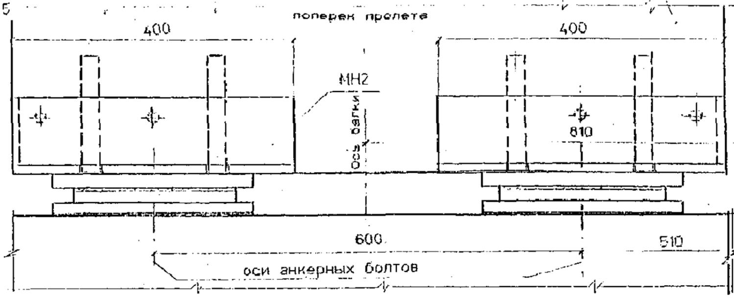
СХЕМЫ ПРИВЯЗКИ ТАНГЕНЦИАЛЬНЫХ ОПОРНЫХ ЧАСТЕЙ ТН;ТП ДЛЯ ПЛИТНЫХ ПРОЛЕТНЫХ СТРОЕНИЙ ДЛИНОЙ 9.3;9.85;11.5;12.2;13.5;14.3 и 16.5м
