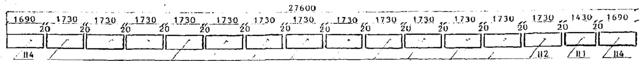
СПЕЦИФИКАЦИЯ ТРОТУАРНЫХ ПЛИТ НА ПРОЛЕТНОЕ СТРОЕНИЕ
