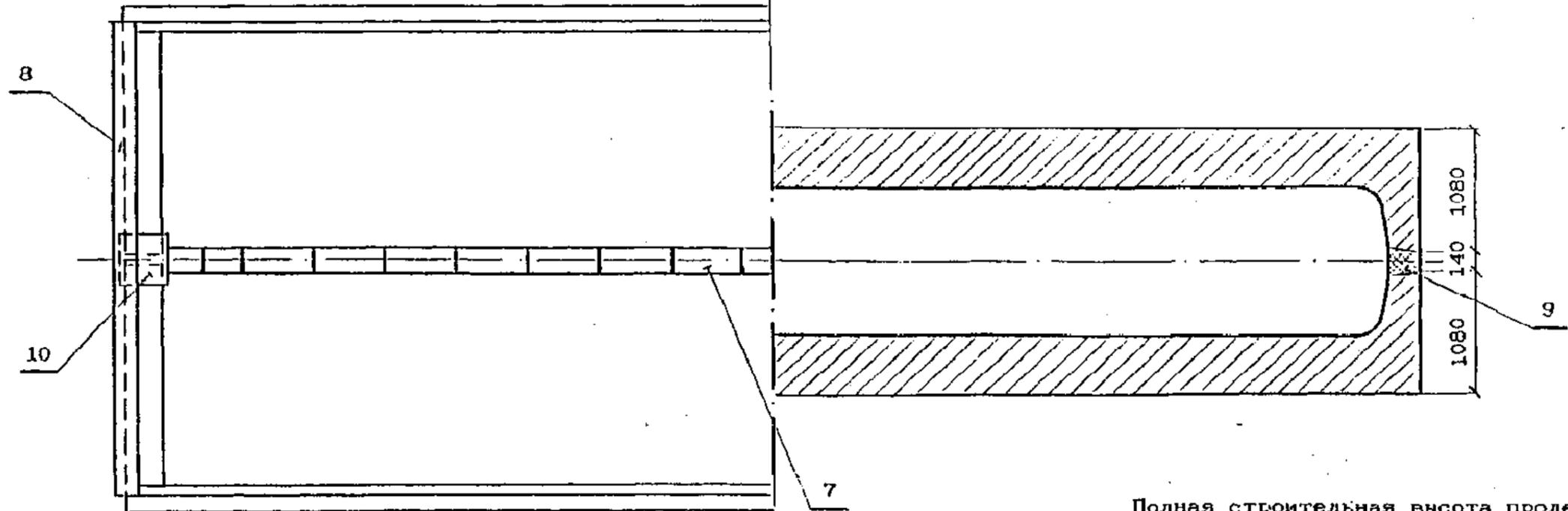
Полная строительная высота пролетного строения ( $h_{стр}$ ) принята, исходя из следующей конструкции верхнего строения пути: - мостовое полотно на железобетонных шпалах; - толщина щебеночного балласта под шпалой - 300 мм.
